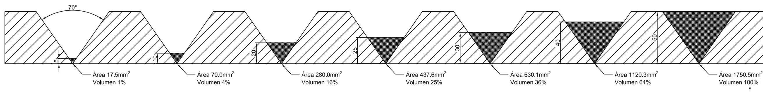
Soldadura a tope con preparación en X por los dos lados.
